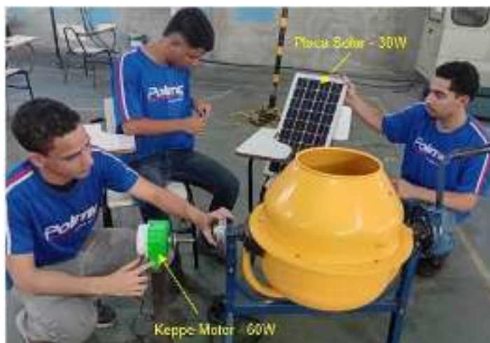
Figura 02 - Alunos do curso técnico realizando a montagem de um experimento prático referente a aplicação do Keppe Motor de 60W, alimentado por uma placa solar fotovoltaica de 30W, sem uso de inversor, para funcionamento de uma betoneira portátil. 2025.
